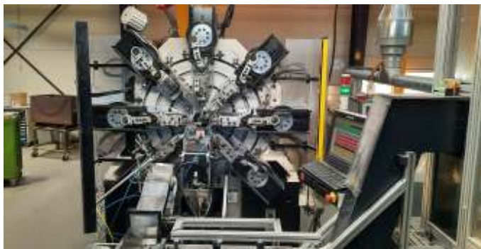
En af maskinerne, der laver fjedre. Bemærk alle armene, der kan tage fat i fjederen på forskellige måder og bukke efter ønske.
