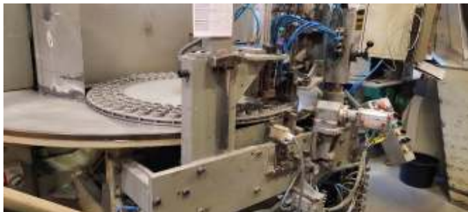
Her slibes der fjedre. Rondellen fyldes med fjedre og drejes ind mellem to slibestene. Når de er slebet, drejes rondellen ud igen og tømmes/fyldes på ny.
