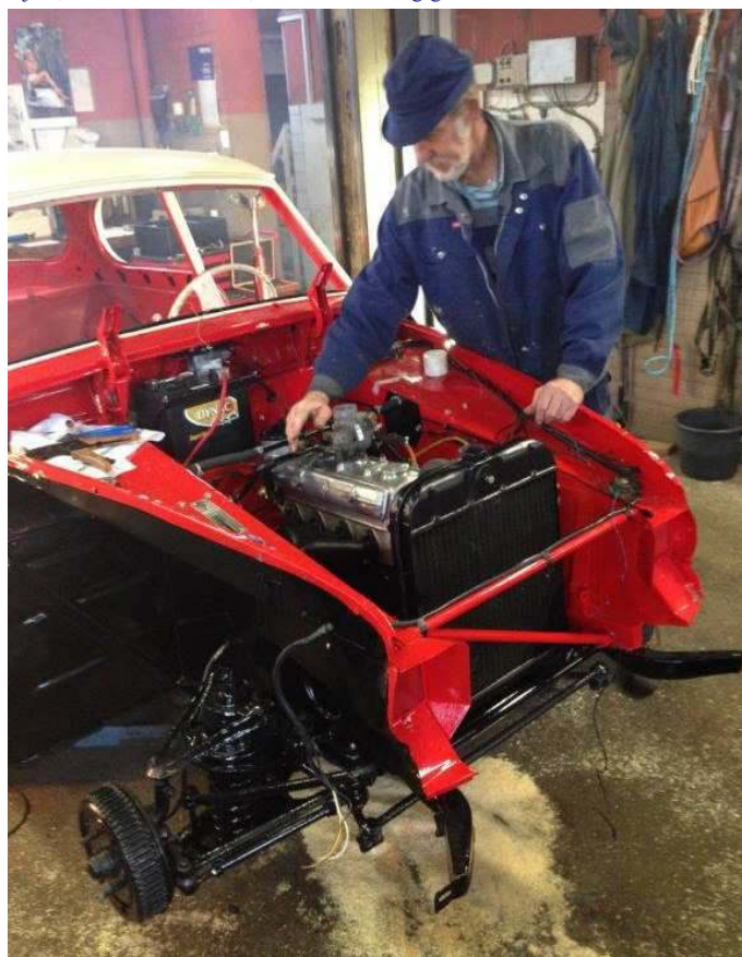
Kjeld har netop monteret motoren i Isabellaen.
