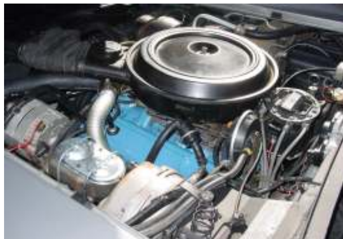
I motorrummet ligger der en 5.7 L V8.
