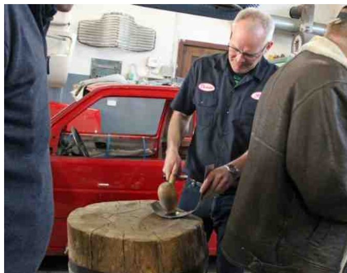
John viser, hvordan man bearbejder plade for at få de rigtige former frem.
