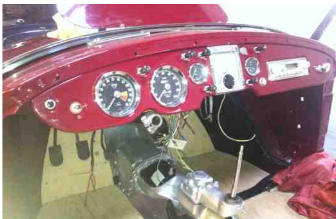
El monteret under instrumentbræt.
