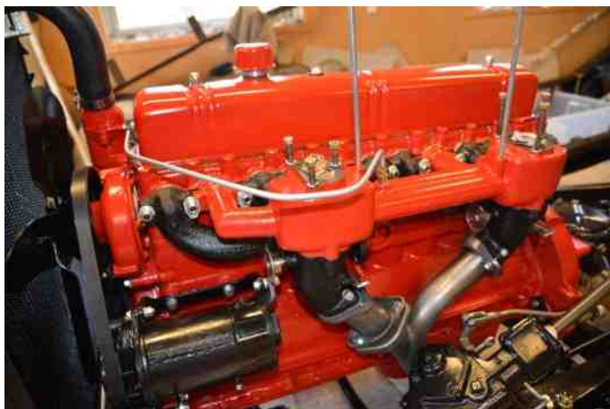
Manifolden og udstødningen er monteret.
