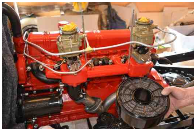
Så er de to karburatorer på plads. Stållulden til luftfilteret, måtte jeg finde ved et traktorfirma, der havde dele til veterantraktorer.
