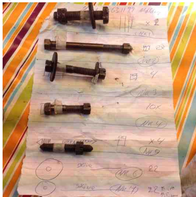
De gamle skruer til montering af karosseriet. Der har jeg fået lavet nye.
