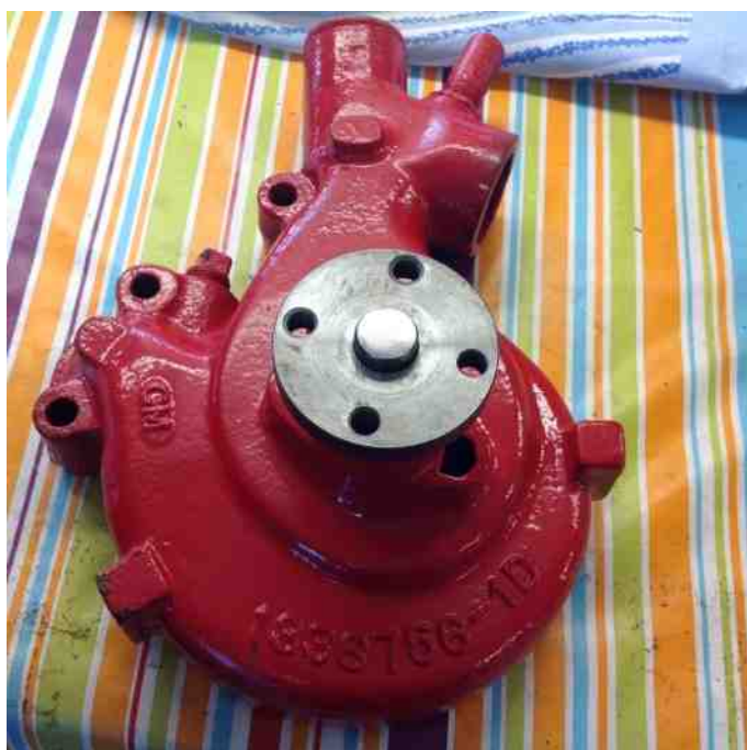
Vandpumpen er blevet repareret, men skal males igen.
