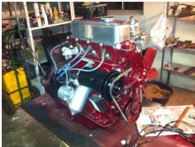
Udrustning monteret, nye pakninger overalt.
