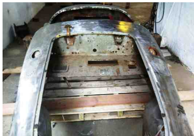
Karosseriet sandblæst og klar til rust reparationer.
