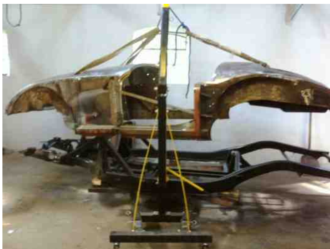
Karosseriet monteres igen på chassis.
