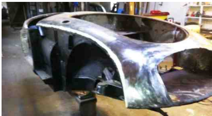
Skærmkanterne er repareret.
