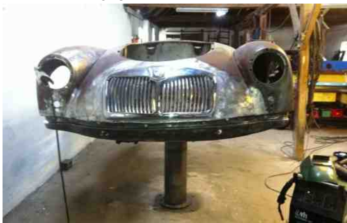
Grillen tilpasses til bilen. (Egentlig er det omvendt).
