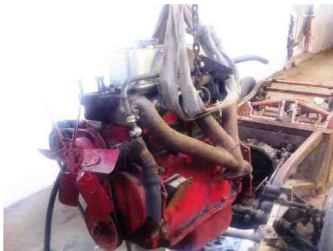
Motor og gearkasse løftes af rammen.
